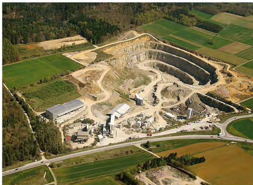
Die Wände, entlang derer abgebaut wird, erreichen bis zu 28 Metern Höhe. Der Abbau zieht sich weniger in die Fläche, sondern geht bis zu 96 Meter in die Tiefe. Foto: Schotterwerk Johannes Mayer
